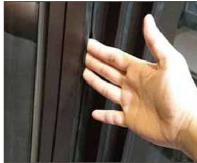
門扇間採用加寬的矽膠密封條，除可耐高溫100度以上不易脆化外，可有效防止因開關門時夾手之疼痛及水密之設計。
