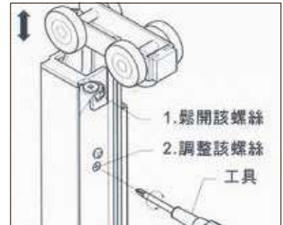
吊輪組預設±3mm的微調位置，輕鬆調整門扇高度，保持門扇間平衡。
